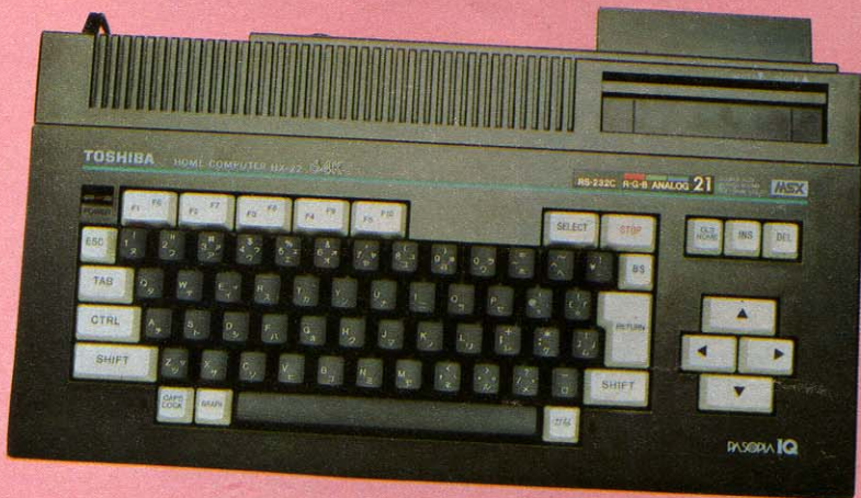
◀ MSX本体：東芝PASOPIA IQ(HX-22) ¥79,800 / 日本語ワープロソフト内蔵(別売漢字ROM必要)、ステレオ音声出力装備、RGB・RF・コンポジット出力内蔵、64KバイトRAM実装、RAMディスク機能、プリントスプーラ機能装備。
