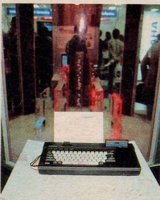
◆YAMAHAのMSXマシンを使ってシンセサイザーとレーザーを制御。ファンクションキーを押すとシンセの音楽が流れ、レーザーが飛び交うのだ。
