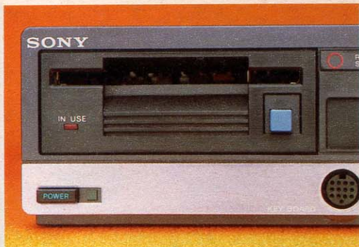
▲これが内蔵された、3.5インチフロッピーディスク。青いボタンがイジェクト。アクセス中には「IN USE」にランプがつく。
