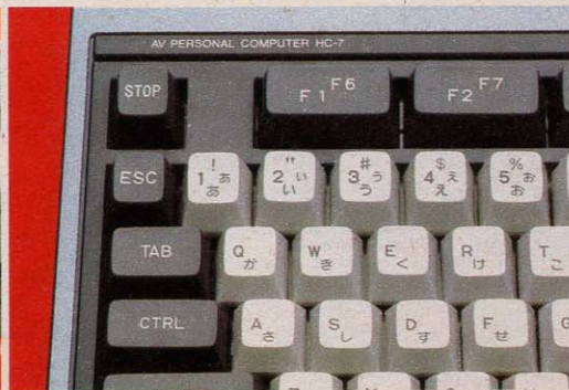
↑キーボードは、すべてクリック入り。MSXではキャノン、東芝の新機種と並んで、最高級のキータッチを誇っている。
