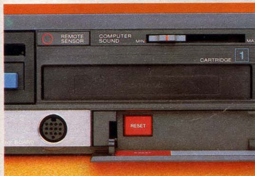
▲前面パネルの下を開くと、リセットボタンがある。左の端子にキーボードを接続。しっかりロックされるので外れることはない。
