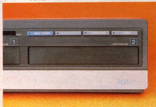
▲「HB-701FD」とかかれたフタを開けると、ジョイスティックのポートがある。イメージ的にソニーのビデオと似たつくりだ。
