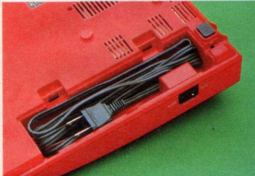
◆本体底部にある、電源コードの収納スペース。スッキリとコードを収めて、街中をコンピュータ片手に歩き回しましょう。
