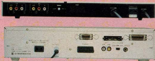
▲ 上がスーパーインポーズユニットCF-2601背面。映像入・出力とステレオ音声入・出力、RGBマルチ(21ピン)。下がCF-3000背面。スーパーインポーズ端子がついている。
