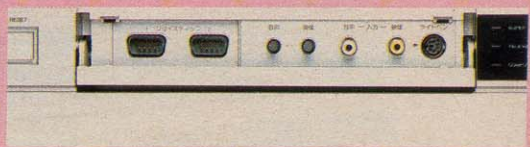
▲映像出力はアナログRGB(21ピン)。オーディオ出力はモノラルで1ch。60ピンの拡張バス接続端子からは、同社のグラフィック拡張ユニットMPC-Xを。正面パネルを開けるとVTRからの映像・音声入力端子が付いている。
