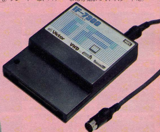
◀ 上から HD-7900背面部分、右はHD-7900とHC-7、またはHC-6と接続するためのVHDインターフェースIF-7900。そのIF-7900の背面部分が左、下はLD-7000とその背面端子部分、一番下はHD-7900と付属のワイヤレスリモートコントロール。
