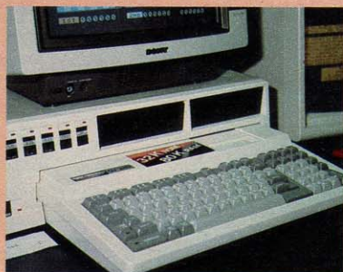
◆◆◆スペクトラビデオの展示には、いろいろな拡張機器がありました。このMSXは64KバイトのSV1-728。手に持っているのは、80桁表示カードリッジ。文字の表示数が2倍以上に増えます。Fにあるのはローカルエリアネットワーク用のマスターステーション。このパソコンが拡張ユニットに差さっています。キャンコンの上に乗っているのが、MSXをスレーブステーションにするためのカートリッジ。その他3.5インチのディスクユニットも出していました。
