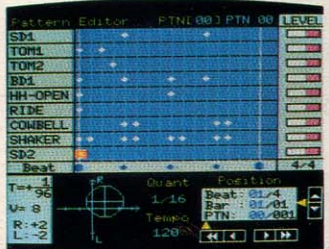
↑リズムパターン入力用のモード。現在の入力位置は赤いカーソルで表示され、パンの状態もグラフィック化される。
