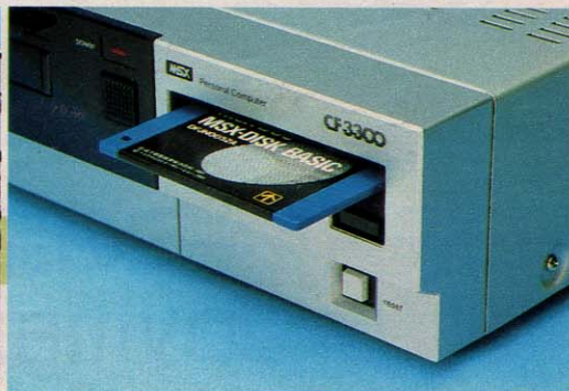
↑内蔵の3.5インチディスク。右下にあるのがリセットスイッチ。
