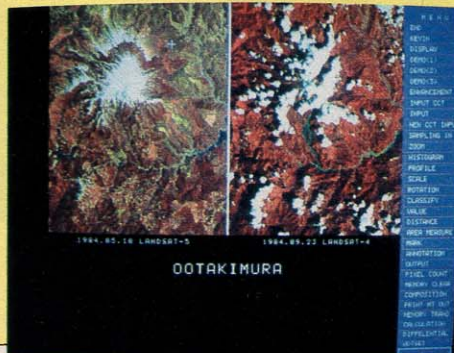
●昨年の大地震で被害を受けた大滝村の様子。左が地震の前、右が直後。土砂が流出した後がハッキリわかる。
