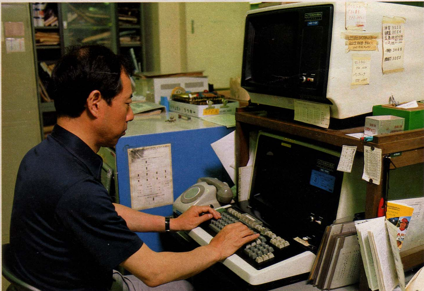
MCRでマークカードを読み取った後、東芝TOSBACで必要な情報を選別し、KPR(漢字プリンタ)で確認してから、新聞社、放送局へデータを送る。通信部の昆布さんにキーボードをたたいてもらった。
