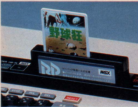
●カードはこのようにコネクタカートリッジに差し込むのだ。
