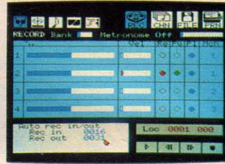
左下のウィンドウは機能別のデータ表示。画面はオートパンチイン・アウトの指定画面。
