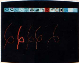
▲ペン・モードで使える各種の線。左から細線、太線、細かい点線、荒い点線、ブラシによる線、色との組み合わせはもちろん自在。
