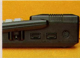
◆マシンの右側面。左のリセットスイッチを間違えて押さないように、左右に突起が設けられている。
