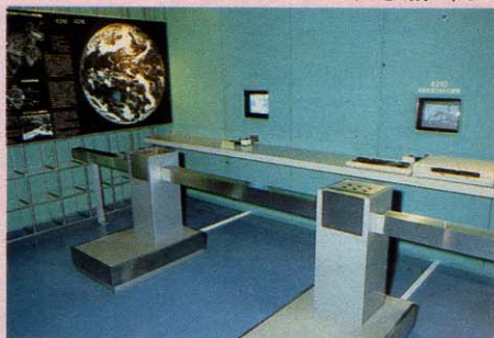
◆気象衛星ひまわりの画像受信システム。右の写真の手前にあるコントローラーを使い、見たい地域にズームしたり、画面をスクロールさせたりが可能。
