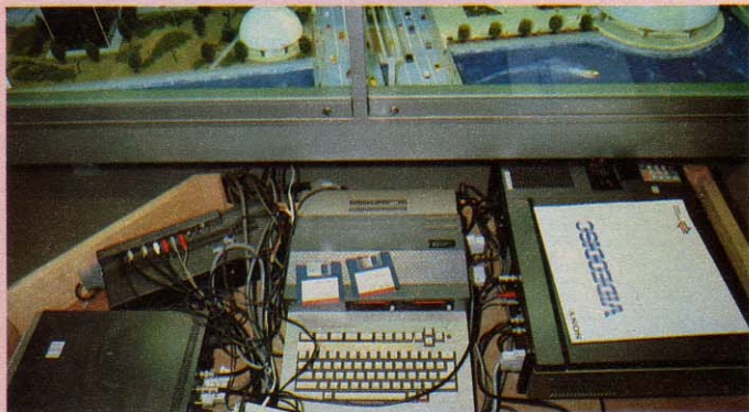
◆LDを使ったIVSシステムの内蔵。ソニーのSMC-70が使われている。
