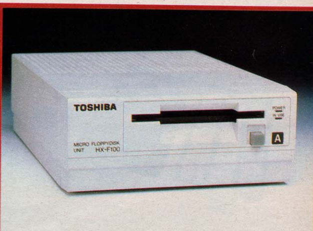
東芝のHX-F100は、IDDのドライブ。このディスクドライブで、2Dや2DDのディスクは読めない。
