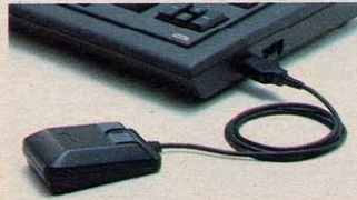
MSXマウスはCX本体右サイドの汎用I/Oポートにつながります。 ●MSXマウス MU-01 ¥12,800
