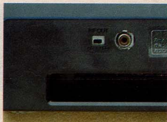
◆本体後面に設けられた、第2カートリッジスロット。上にあるのは、RF出力のコネクタだ。
