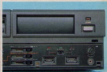
◆ボールマウスはジョイスティックポートを兼用している。場合に依りてポート1と2を使い分ける。
