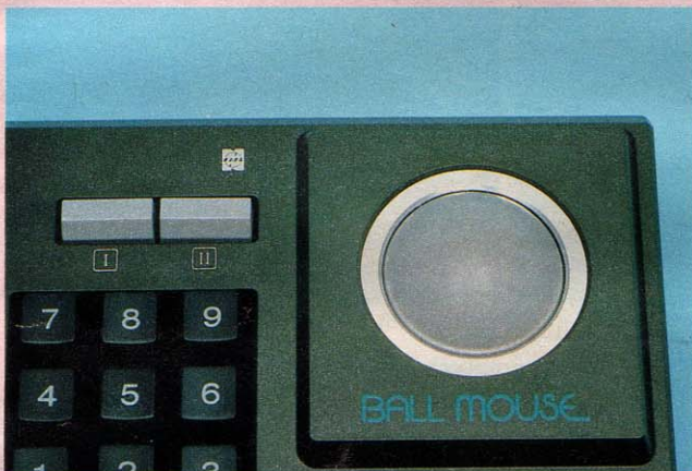
▶ボールマウスという名称を与えられた、キーボード上のトラックボール。左に並んだ2つのボタンが、トリガーの1と2。動きは、かなりカチッとしたもので、妙な遊びなどはない。
