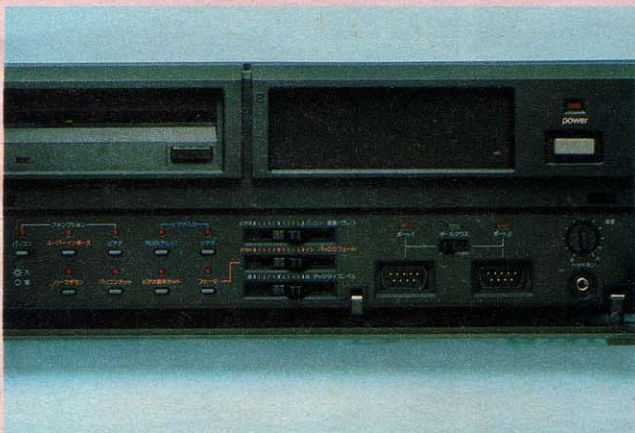
▶シーリングパネル内の各種スイッチ。汎用1/0ポート上のスライドスイッチが、ボールマウス選択のためのもの。LEDで表示される。右端はヘッドホンジャックで、音量調整が付く。
