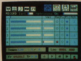
レコーディングモード(録音した小節の量がトラック別にバークラフ表示されます)。
