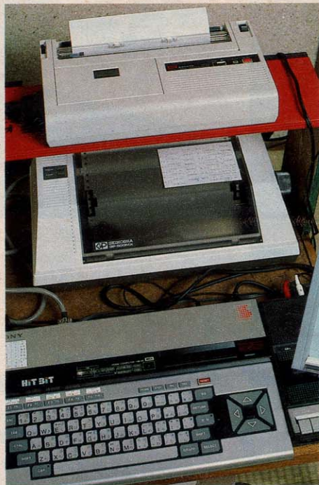
◀MSXマシンはSONYのHB-55。プリンタはセイコー社のドットプリンタGP-500MXと、サンヨーのカラー・プリンタMPT-C10の2機種。プリント・アウトはハードの性質、命でございます。
