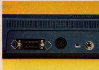
◆左からプリンタ・インターフェイス、カセット・インターフェイス、RF出力の各コネクタ端子。
