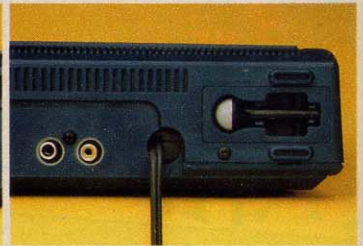
◆左がビデオ出力。カーソルジョイスティックの、スティック部分を収納するスペースが、新たに設けられた。
