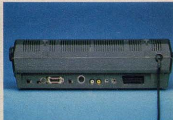
◆ワーコンのリアパネル。プリンタI/Fが付いているのは、外部のプリンタも使えるようにとの配慮だ。
