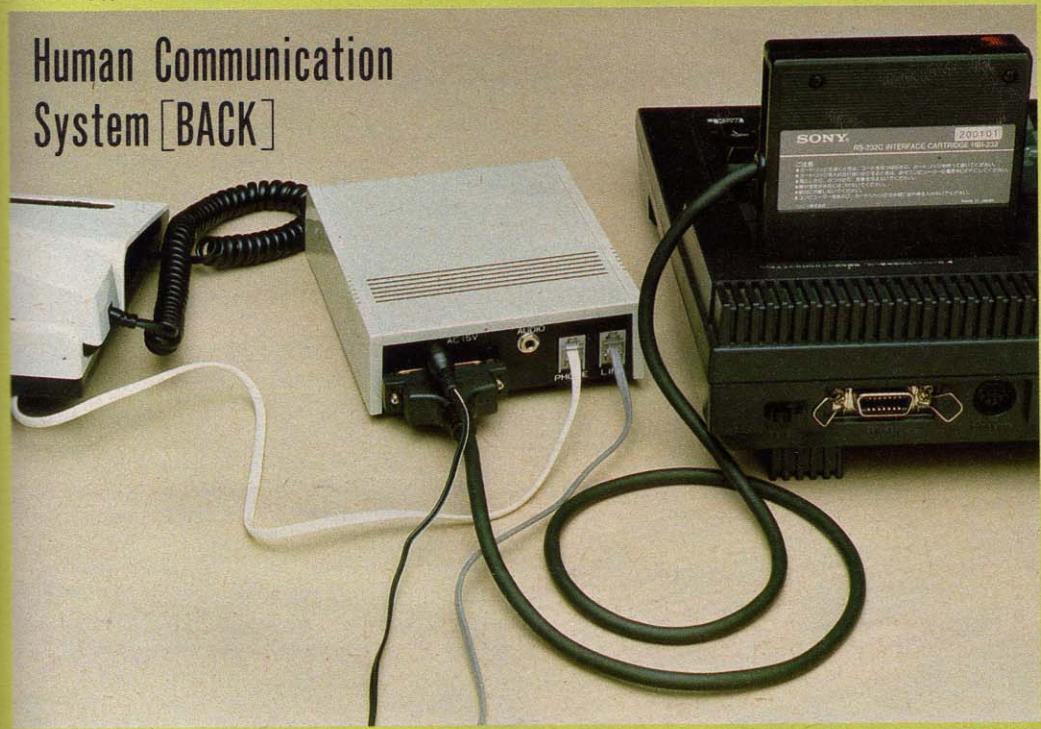
◆RS-232Bケーブルは何処に、電話線は何処に配線されているのかをよく見てほしい。配線を誤がえるとネットワークへアクセスできない!!
