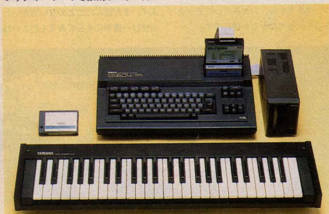
本体にSFGをすっきり内蔵させ、ミニキーボードとディスクを付けた標準的なシステム。
