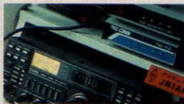
◆TNCは無線機とパソコンの間に設置する。
