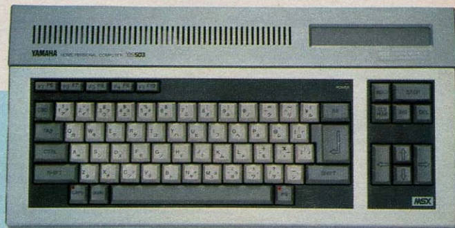
↑ヤマハのYIS503。FM音源ユニットなど底面の専用スロットで音楽ソフトに対応。
