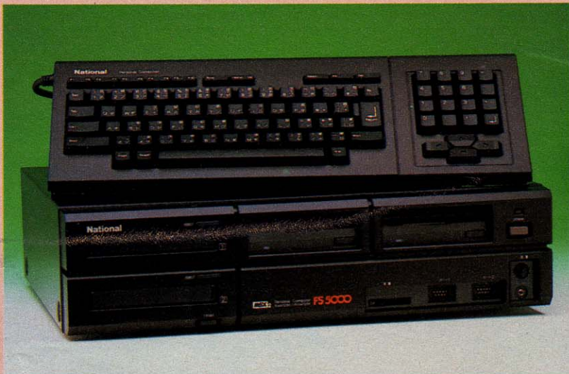
↑音声出力はステレオ。上に拡張ボードを差す。
