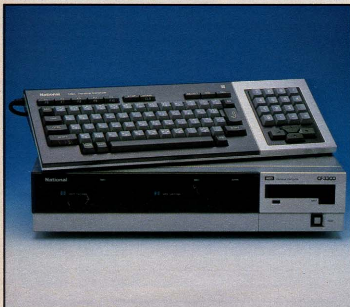
←松下・CF-3300。MSX初の2DDディスクドライブ内蔵機。派手なマシンではないが、シンプルで扱いは楽だった。
