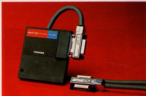
◆東芝から発売されたGP-1Bカートリッジ「HX-GP10」。IEEE-488準拠のインターフェイスで、各計測機とMSXを接続する。
