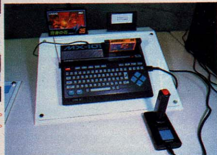
◆見てビックリのワープロユニット。24ドットのプリンタが一緒になった。 ◆UHF波で電波を飛ばす、カシオのワイヤレスMSX「MX-101」。
