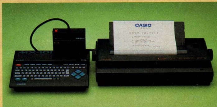
◆ワープロユニットと組み合わせたところ。カートリッジスロットで接続するだけだから簡単だ。印字は24ピンのサーマル。
