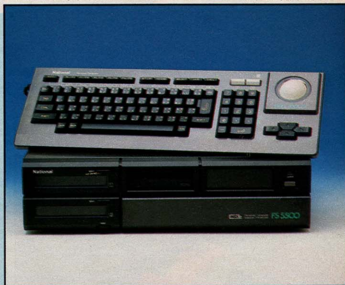
↑FS-5500F I。2ドライブのF 2もある。多機能グラフィック機。ボールマウス付。
