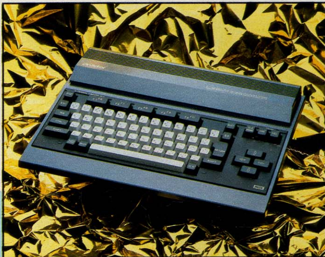
↑ヤマハのYIS503。FM音源ユニットなど底面の専用スロットで音楽ソフトに対応。
