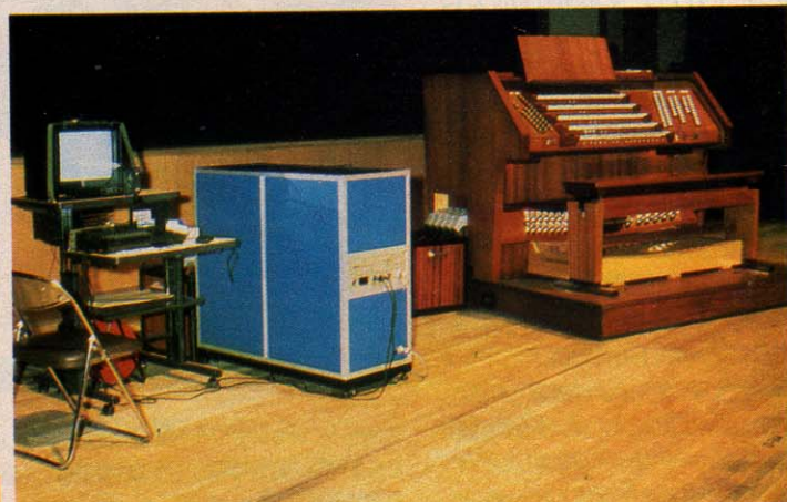
写真の左よりヤマハミュージックコンピュータCX7M/128を中心としたMSXコンピュータ自動演奏システム、オルガンインターフェイスユニット、電気式演奏台。
