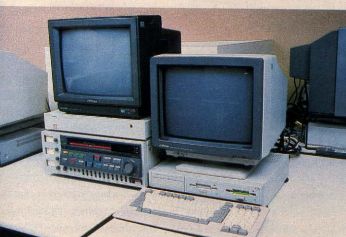
IF-2000・2001およびHC-95/90等で構成されるC.G.レコーダー。大掛かりでしかも高価な装置でしか実現できなかったC.G.のアニメーション利用を、身近なものとした。
