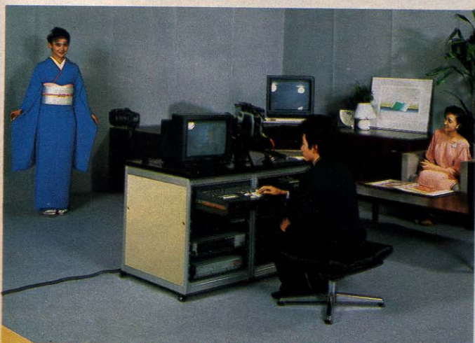
■ブルー無地の着物を着装し、銀無地の帯を締めた顧客本人の姿をカメラで撮影し、画像合成により着物の柄を重ね、好みに合うかどうかをモニター画面で確認する。
