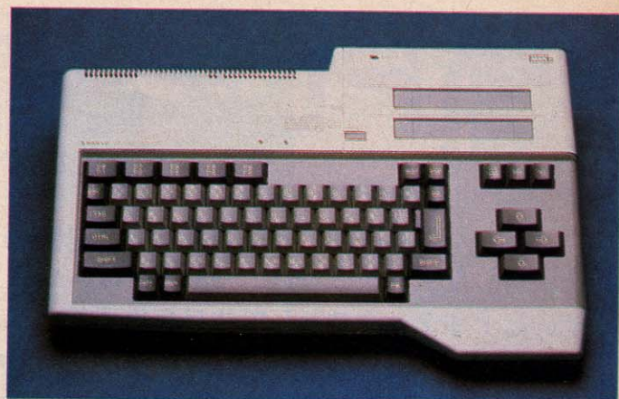
WAVY-1、WAVY-2と同じ型だが、中身はMSX2。昨年末発売されたWAVY-23とも違うこのマシンは、LAN教育システム用の特別なもの。市販されている同型のMSXと違うところは、左写真を見てわかるように、背面のビデオ端子の横に、同軸ケーブルを接続するための端子が装備されているという点。
