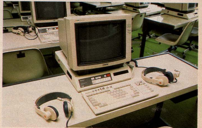
◆生徒側の学習ターミナル。キーボード2台で個別学習ができるが、北谷中学では1台のキーボードを2人で使って、協力し合いながら学習する方針を採用。モニタ下部のエデュケーショナルユニットを操作して先生に質問したり、答えたりできるようになっている。
