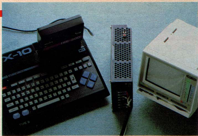
MSX-10と超小型テレビを組み合わせたコンパクト通信システム。モデムの大きさと比べてみて。
