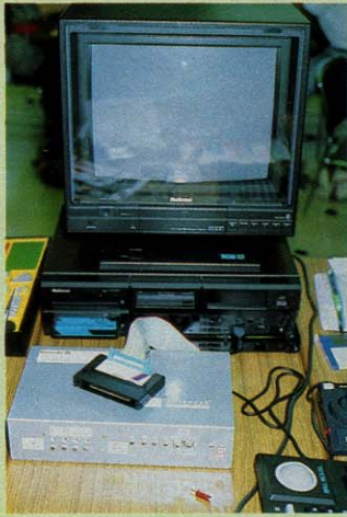
◆これが自作のインターフェイス。カートリッジ・スロットから拡張して使用しています。
