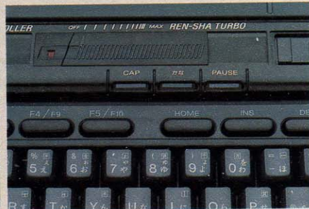
■左がFIXD、右がF1II。両者ともにスライド式のスピードコントロールキーと、連射ターボキーが設けられている。
