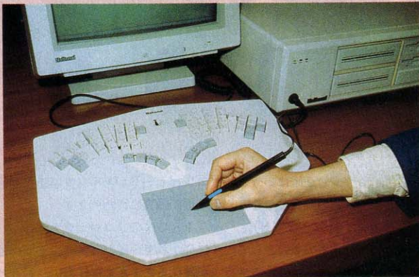
◆人間工学を考慮して作られたTRON仕様のキーボード。従来のものとはまったく違った形をしている
