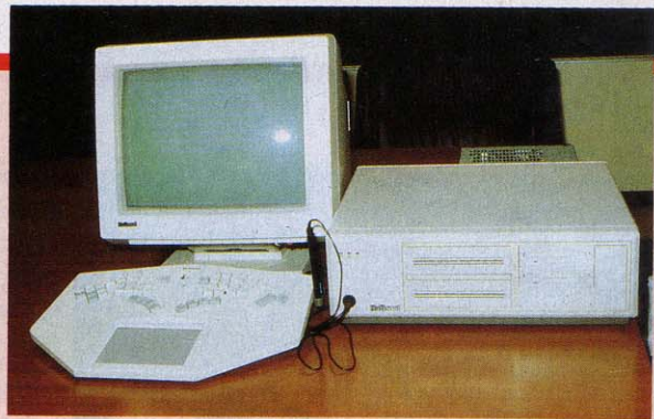
●松下電器が開発したBTRONの実験機 80286 CPUを採用し、2Mバイトのメインメモリを搭載している。
