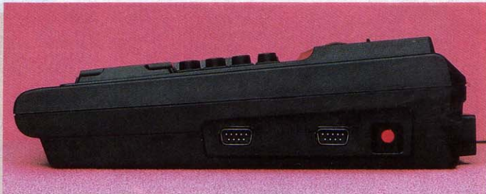
▲A1FMの側面図。リセットスイッチとジョイスティックポートが並んでいる。かなり薄く作られているけど、キーボードの下にディスクが収まっているから不界議だ。
