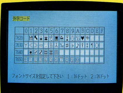
●外字コード画面→登録した外字を一覧表示。どんな外字を登録したのかを一目で確認できます。
