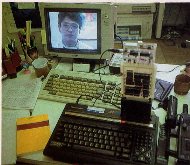
▲MSX2+用、画像取り込みユニットの試作品実験風景。背高ノックのカートリッジは配線ビッシリの手作りの品。さて、このユニットが正式に発表されるのはいつ？
