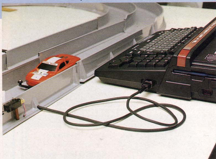
◆コースを組み立てて、ジョイスティックポートに差し込めば準備OK! さあ、レース開始だ。
