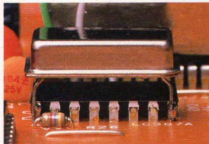
◆少し強引という気もしますが、こんな感じでオシレータの足を広げて、LS367の上にハンダづけをします。
