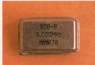
◆6MHzのオシレータ。ピンの位置は、下の図を参考にしてください。
