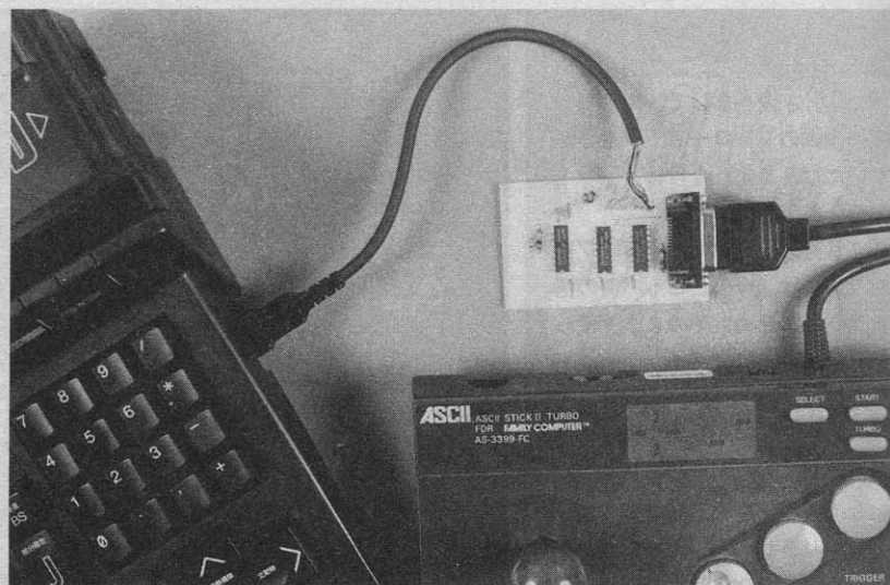
◆完成したものを実際に接続してみた。このようにして、ファミコン用のジョイスティックを使えます。
