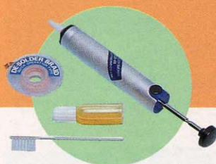
◆ハンダ吸い取り器(線)は、今回の改造で必ず揃えておかなければならない。
