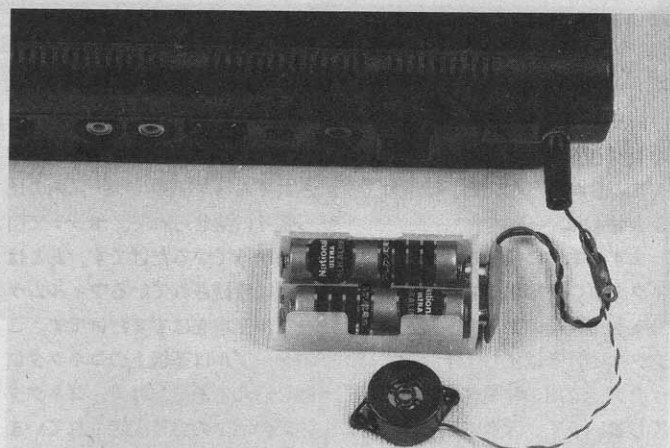
■こんな感じでブザーを取りつけて、セットした時間に鳴らしてやることのできるんだ。
