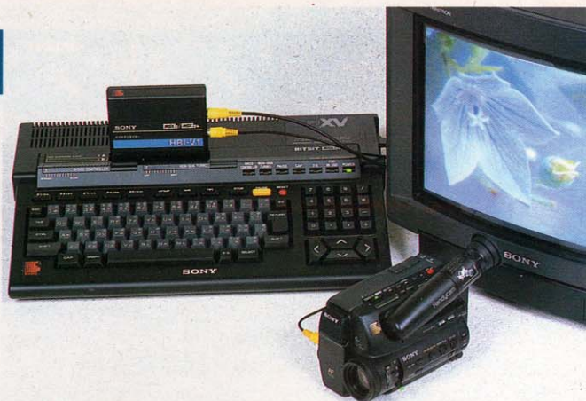
▶MSX2+マシンにHBI-V1、そしてビデオカメラとモニター。これが基本システムだ。
