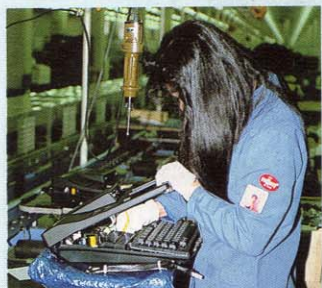
◆キーボードとディスクドライブをセット。配線もあるので気を使うところだ。
