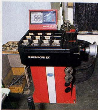
◆これが、従来のホイールバランサー。ほとんどの振動は、これを使うことで解消されるということだった。
