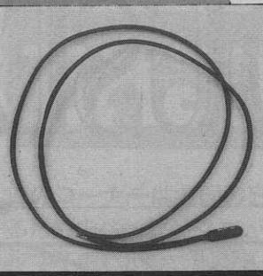
高感度サーミスターです。温度の変化によって回路のオン・オフを制御するなどの、応用が考えられます。
