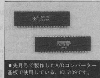
▲先月号で製作したA/Dコンバーター基板で使用している、ICL7109です。
