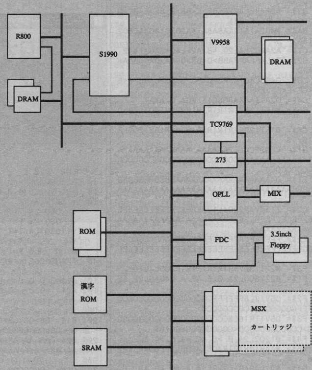
turbo Rのハードウェア構成を、細かい制御信号線を省略して簡単に表わしてみた。まず画面表示をコントロールする、VDPのV9958からの出力はビデオ信号に、その下のTC9769(Z80を含むシ
