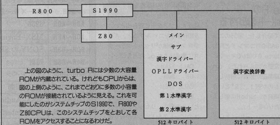
上の図のように、turbo Rには少数の大容量ROMが内蔵されている。けれどもCPUからは、図の上側のように、これまでどおりに多数の小容量のROMが接続されているように見える。これを利用したのがシステムチップのS1990で、R800やZ80CPUは、このシステムチップをとおして各ROMをアクセスすることになるわけだ。
