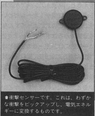
▲衝撃センサーです。これは、わずかな衝撃をピックアップし、電気エネルギーに変換するものです。
