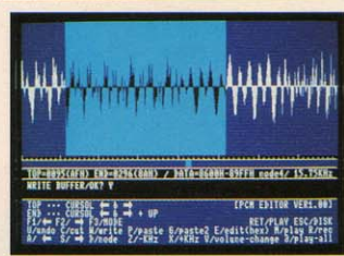
◆このようにしてバッファーに書き込まれたPCMデータは、何度でも繰り返し張り付けることができるのだ。
