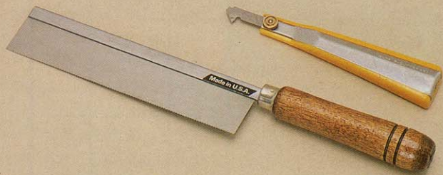
◆ケースの加工に使ったPカッターとピラニアのこぎり。糸ノコでもいいけど、真っ直ぐ切るのが難しいよ。
