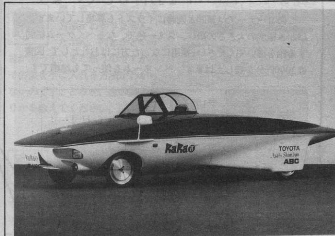
▲これが RaRa II だ。2馬力、重量 210キログラム 後輪をベルトで駆動するRR方式だ。
