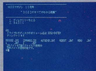
▲「MENU.BAT」を実行すると……ほーらちゃんとディレクトリーが取れたぞ。
