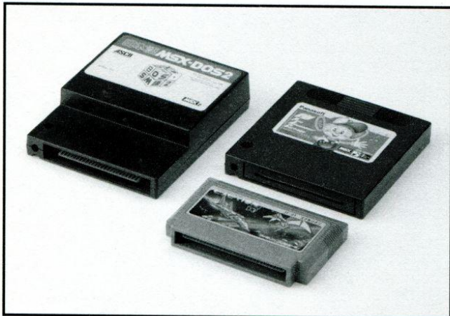
MSX-DOS2カートリッジと、松下電器から発売されたFM音源カートリッジ「FM-PAC」。MSXのスロットにはシステムを拡張する製品がいろいろあった。なお、右下は参考までのファミコン用カートリッジ。
