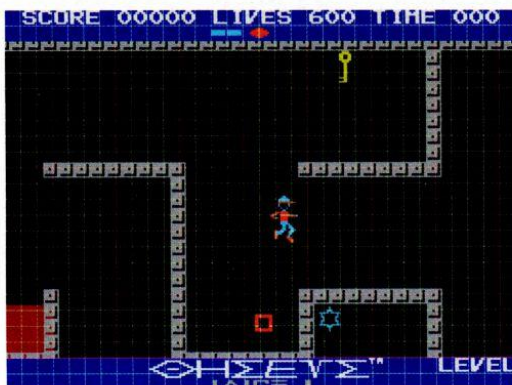
図3 スクリーンショットに、背景スクロールのキャラクタパターンの境界線を加えたもの。赤のラインで区切った4×4ブロックでマップを管理している。
