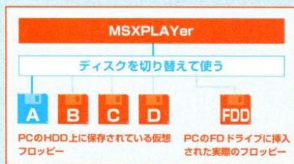
図2 仮想FDDの仕組み。A~D、FDDドライブはMSXPLAYer上でいつでも切り替えられる。
