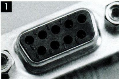
1 まず、ATARI端子のピン配置を確認する。必要なのは5番ピンの電源（+5V）と9番ピンのグラウンド（GND）だ。
