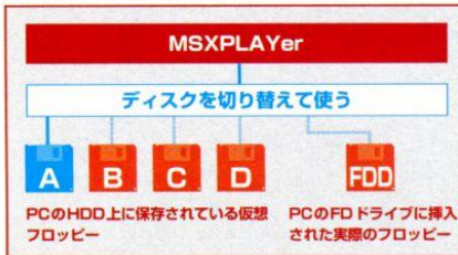
画面2 仮想FDDの仕組み。A~DドライブはMSXPLAYer上で切り替えられる。
