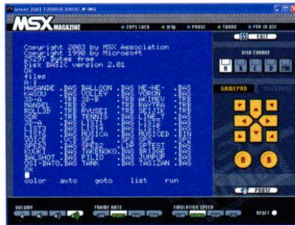
画面3 仮想フロッピーディスク「A」を選択し、FILES コマンドを実行した結果。
