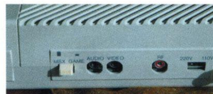
MSX/GAME (メガドライブ) を切り替えるためのスイッチ。日本で発売されたテラドライブ (PC互換機+メガドライブ) を彷彿とさせる。
