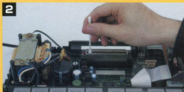
2 綿棒を垂直に抜き差しして、端子すべてを掃除する。
