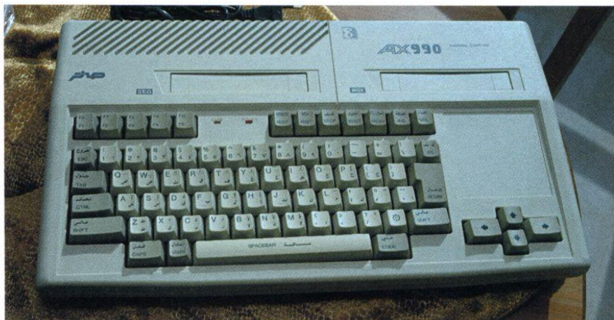
左側がメガドライブ用のスロット、右側がMSX用のスロット。この時期にあえてMSX1規格を採用しているのは謎である。
