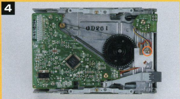
ネジ(1本)を取って、ディスクドライブ裏側の回転検出用基板を外す。
