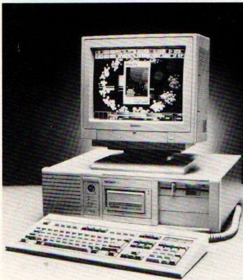
De Tandon 386/33 heeft een geïntegreerde 'Personal Data Pac' verwijderbare harddisk
