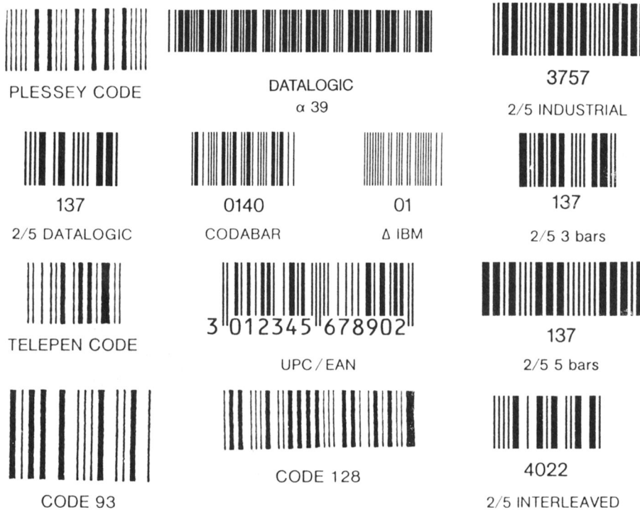
Figuur 1: Voorbeelden van een aantal van de meestgebruikte barcodes.
