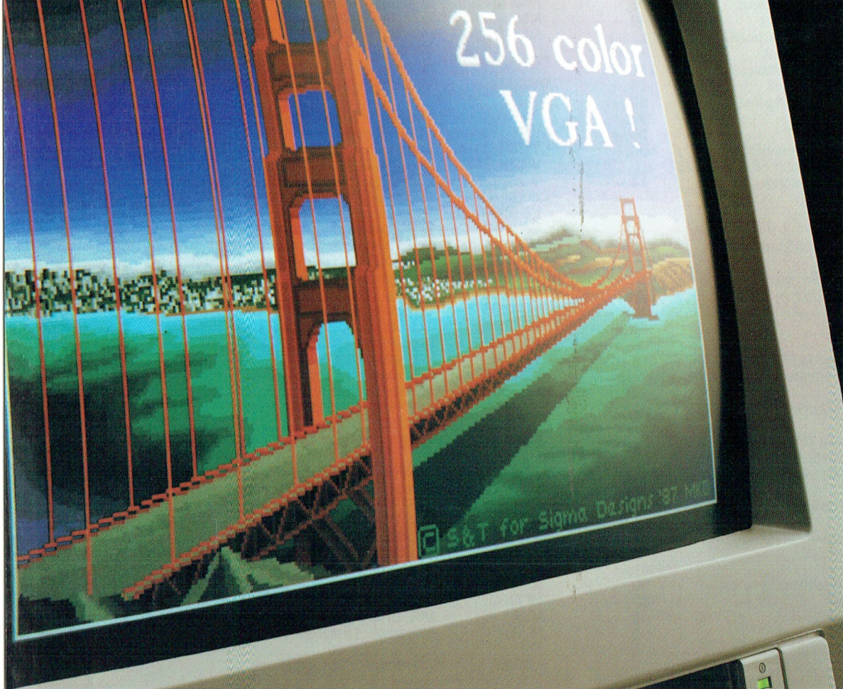
3 CM 9809. VGA Pro-Line kleurenmonitor. Resolutie 640x480 beeldpunten. Schermdiameter 34 cm. Lijnfrequentie 31,5 KHz. Rasterfrequentie 60-70 Hz. Anti-reflectie (geëts) black matrix scherm. Pitch 0,29 mm. Bandbreedte 30 MHz. Inclusief verstelbare voet en aansluitkabel.
