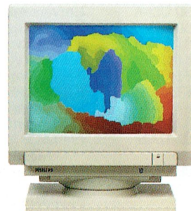
3 CM 9809. VGA Pro-Line kleurenmonitor. Resolutie 640x480 beeldpunten. Schermdiameter 34 cm. Lijnfrequentie 31,5 KHz. Rasterfrequentie 60-70 Hz. Anti-reflectie (geëts) black matrix scherm. Pitch 0,29 mm. Bandbreedte 30 MHz. Inclusief verstelbare voet en aansluitkabel.
