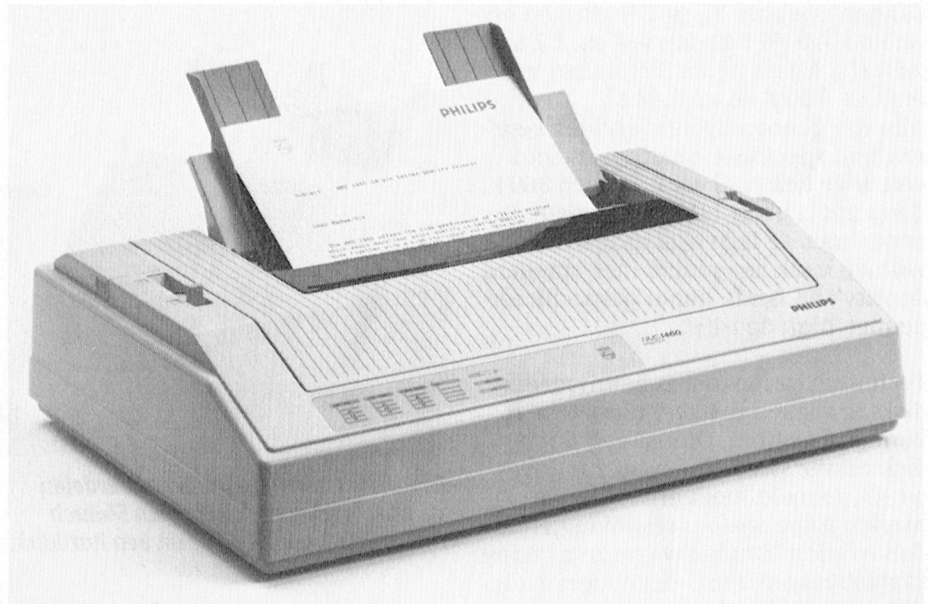
De Philips NMS 1437, voorbeeld van een 9 naalds matrixprinter.
