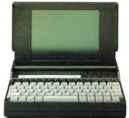
PCL 203. Compacte lichtgewicht notebook-AT. 12 MHz 80C286 processor. 20 Mb harde schijf. 3,5" diskettestation (1,44 Mb). 220x280x52 mm. Gewicht 3 kg. Prijs f 5.995,-.
