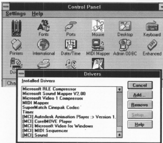
Quando é dado um double-click no ícone Drivers, abre-se a janela Drivers, onde se tem a possibilidade de remover, adicionar ou configurar os dispositivos instalados no Windows.
