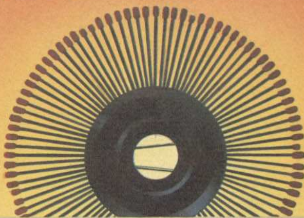
Dispostas em torno de um anel (acima), as agulhas da impressora "margarida" são equipadas com caracteres em relevo que imprimem sobre o papel (abaixo).
