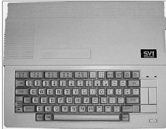
É o SVI-738, fabricado pela Spectravideo e também conhecido pelo apelido de “XPress”. Ele é um MSX1 “portátil” contendo um drive de 3½”, porta serial RS232C, cartão de 80 colunas, bolsa para transporte e um tampa traseira que se transformava em uma prática alça para o transporte ou suporte para o teclado (você escolhe).
