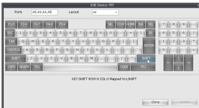
Podemos cambiar la tecla que queramos y actualizar la plantilla, con UPDATE. O bien, podemos clonar la plantilla y asignarle otro nombre. Todas las plantillas se encuentran en la unidad del sistema `"$SYSTEM/vmachines/kbd-layouts/"`. Estas plantillas se guardan en formato XML.
