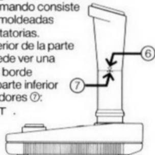
Cuando se coloca la marca ⑥ enfrente del indicador T la palanca de mando sólo se podrá mover sobre una distancia limitada. Cuando se coloca enfrente del indicador TTT , la palanca de mando posee su movimiento máximo. Las tres posiciones tienen un clic de parada.
