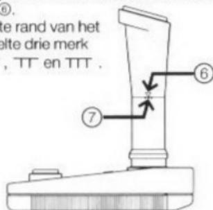
Plaats u de markering ⑦ tegenover het merktekentje T , dan heeft de stuurknuppel een heel beperkte bewegingsvrijheid. Plaats u het daarentegen tegenover tekentje TTT , dan heeft de stuurknuppel zijn maximale bewegingsvrijheid. Alle drie standen hebben een klik-stop.
