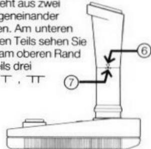
Wenn Sie die Marke ⑥ dem Indikator T gegenüberstellen, ist der Bewegungsbereich des Hebels begrenzt. Wenn Sie die Marke dem Indikator TTT gegenüberstellen, ist der Bewegungsbereich maximal; bezeichnet die Mittelstellung. Jede dieser drei Stellungen wird durch Einrasten arretiert.
