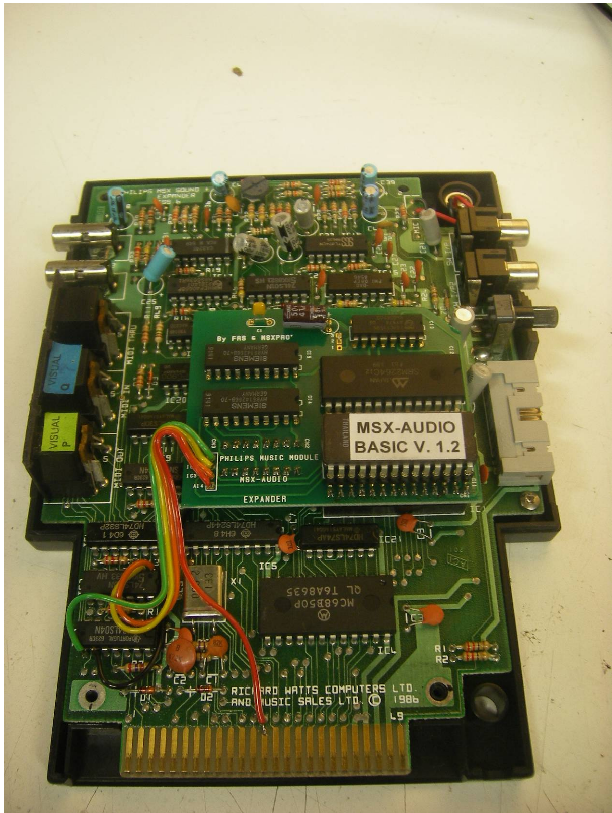
De uitbreidingsprint in de Philips NMS 1205 Music Module
